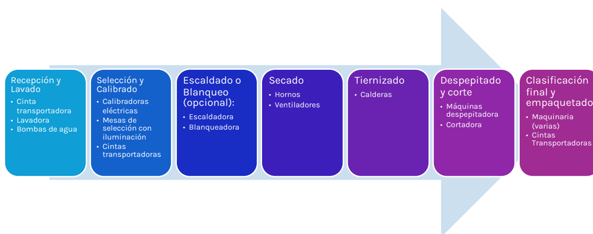
Figura 5. Procesos Generales y ejemplos de equipamiento utilizados en el proceso de planta.
