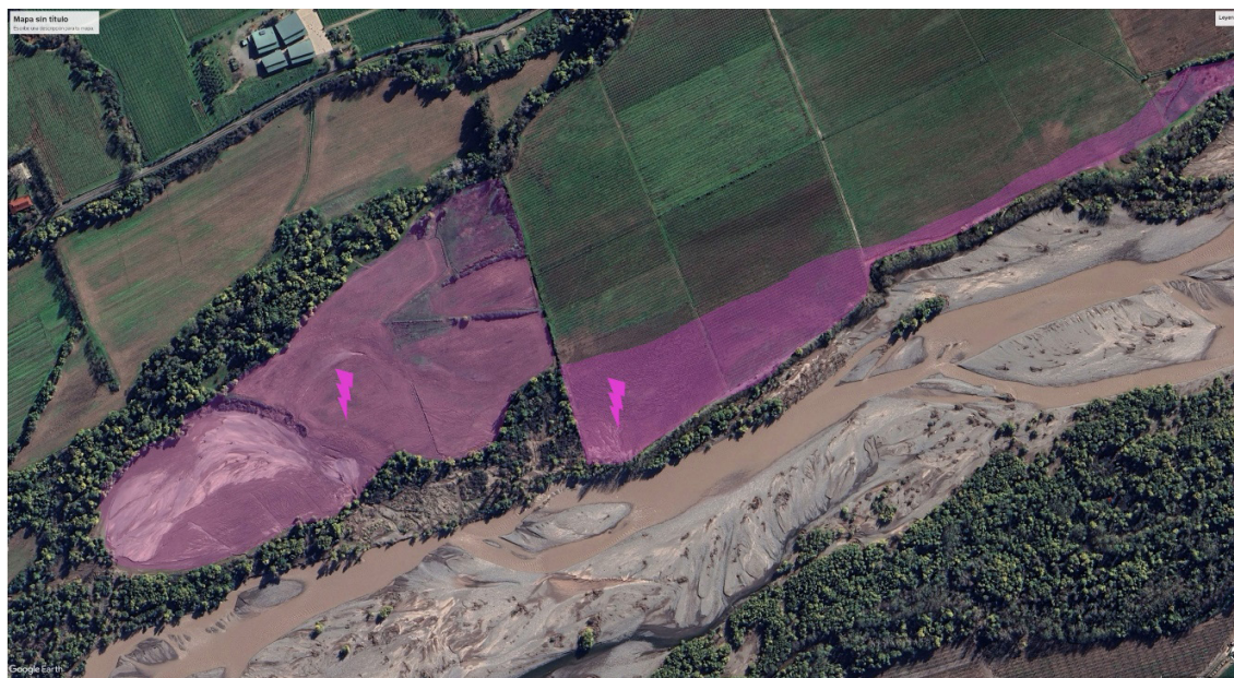
Figura 12. Vista aérea desde Google Earth de la vegetación de ribera de un río y un predio frutícola. La falta de vegetación ribereña ha resultado en inundación de los cuarteles (áreas de coloración lila) y procesos de erosión (símbolo lila). Estos espacios identificados en lila podría ser parte de programas de restauración y gestión de biodiversidad del predio.
